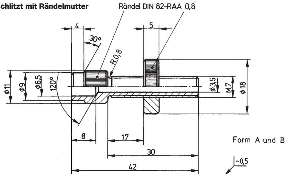
**Form B geschlitzt mit Rändelmutter**
